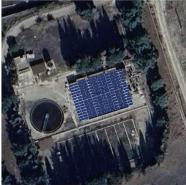
Simulazione Impianto 70 kW "Depuratore Pianto delle donne" - 37°49'20.78"N, 12°48'55.48"E
